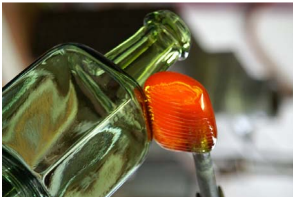
Ansetzen des Henkels an den Flaschenkörper.
