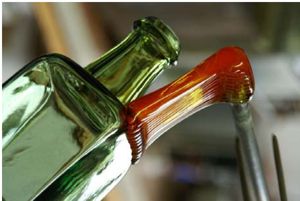
Ausziehen und Ausrichten des Henkels.
